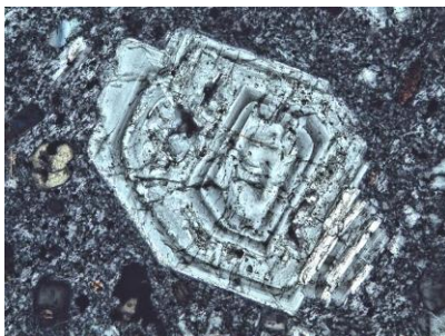
Abb. 3.3.1 -12,13,14: Dünnschliffe vom Lohrbergtrachyt unter dem Polarisationsmikroskop, Bild links und Mitte: Plagioklaskristall mit Zonarbau, rechts: Sanidin-Zwilling. (Von ADELMANN, 2011)
